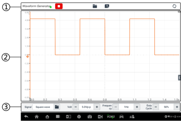
Figur 9-85 Menuskærm for bølgeformgenerator
