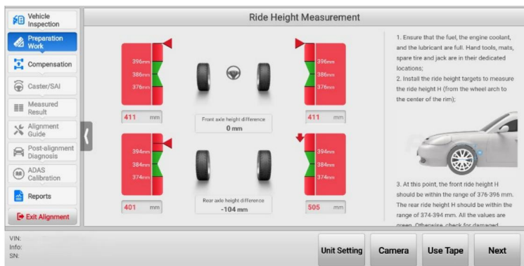
Рисунок 5-41 Вимірювання висоти дорожнього просвіту за допомогою цільового значення висоти дорожнього просвіту
