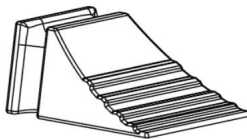
Рисунок 3-6 Упор для колеса
