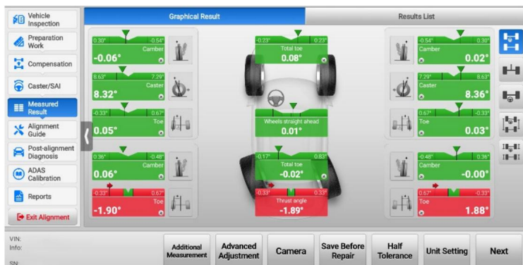
Figur 5-57 Skärmbild för mätresultat (grafiskt resultat)
