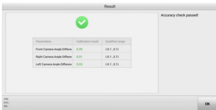
Figur 4-57 Resultat av snabb noggrannhetskontroll
