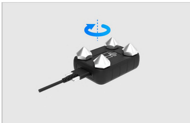
Figura 4-14 Efectuarea calibrării inclinometrului portabil 4
