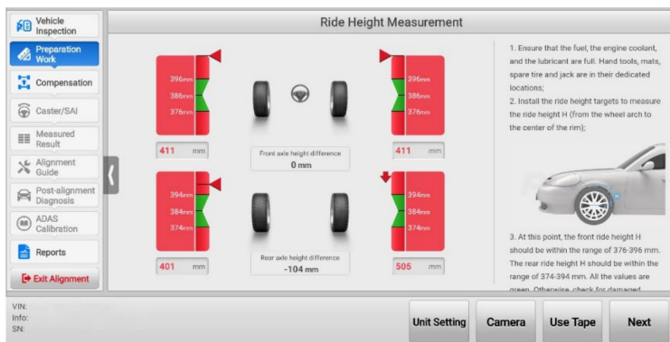
Figura 5-41 Măsurarea înălțimii de rulare cu ținta de înălțime a rulării
