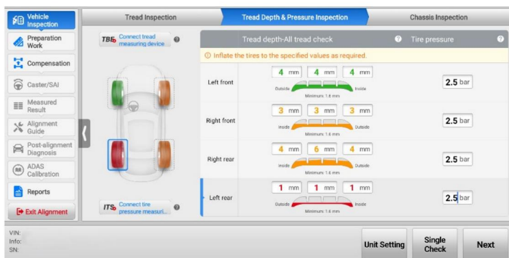
Figura 5-27 Tela de Inspeção de Profundidade e Pressão da Banda de Rodagem 2
