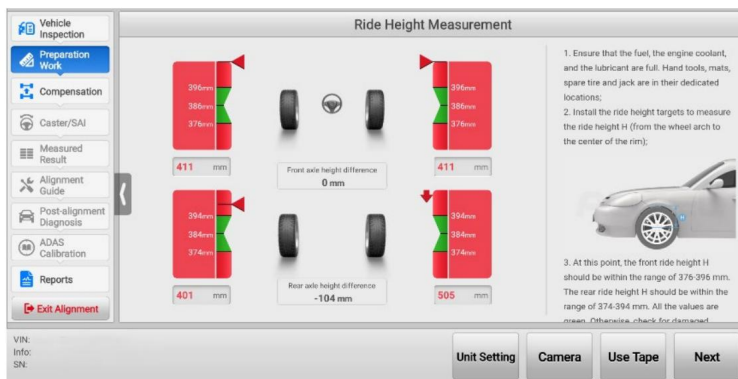
Figura 5-41 Medir a altura da suspensão com o alvo de altura da suspensão
