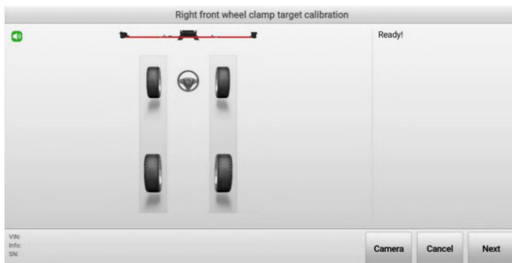
Figura 4-35 Avvia calibrazione (usa veicolo) 2
