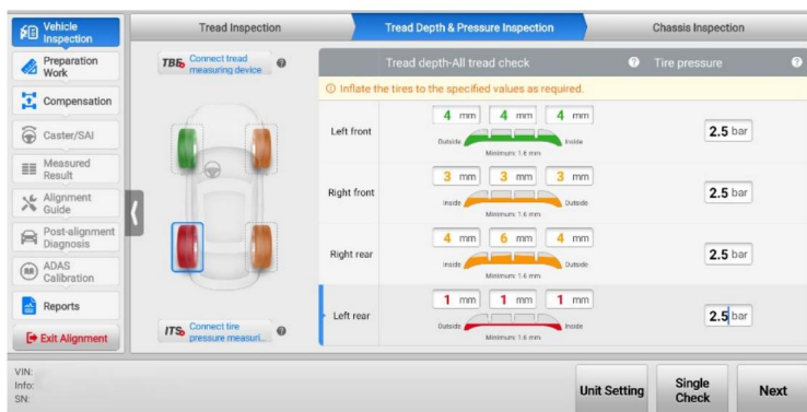
Figura 5-27 Schermata 2 di ispezione della profondità e della pressione del battistrada
