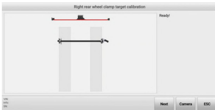
Figura 4-29 Avvia calibrazione (utilizza barra di calibrazione) 1
