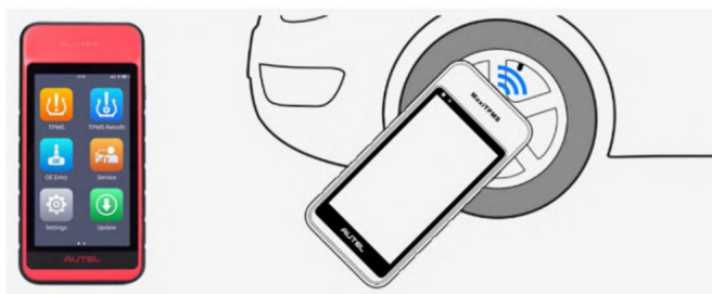
Figure 5-26 Schéma de l'appareil et de son utilisation ITS600
