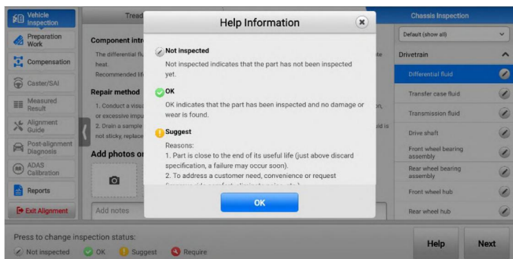
Figure 5-30 Écran explicatif de l'icône d'état d'inspection du châssis
