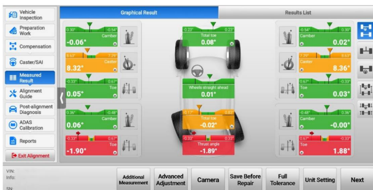
Σχήμα 4-66 Οθόνη Αποτελέσματος Μετρήσεων (Μισή Ανοχή)
