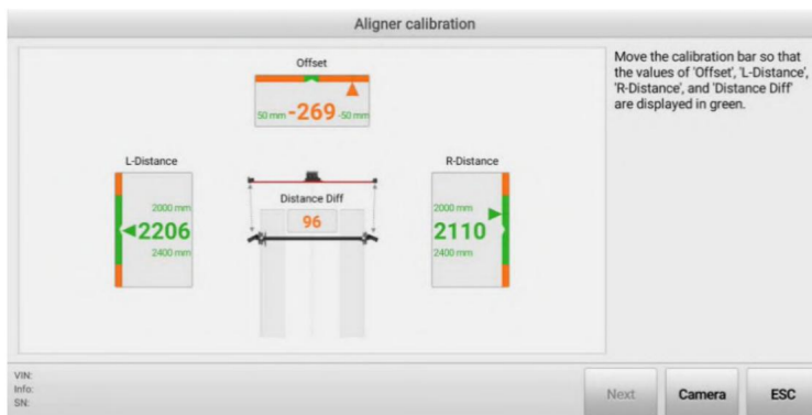
Abbildung 4-19 Kalibrierung des Ausrichtgeräts 1
