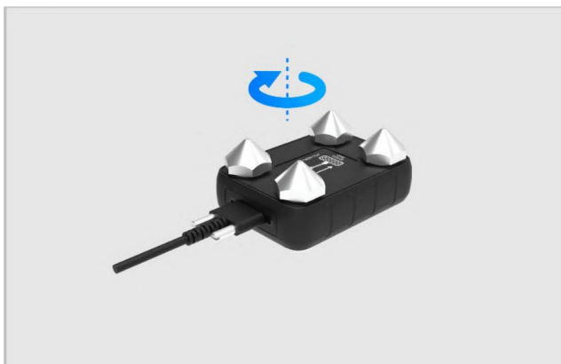
Figur 4-14 Udfør kalibrering af håndholdt hældningsmåler 4
