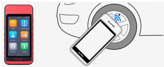
Figur 5-26 ITS600-enhed og brugsdiagram
