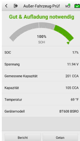
Abbildung 5-2 Beispielhafte Testergebnisse außerhalb des Fahrzeugs
