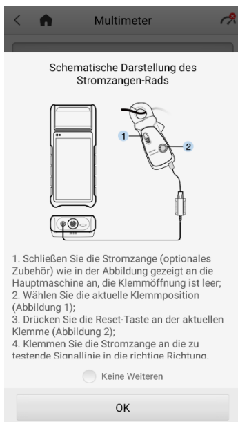
Abbildung 9-3 Beispielhaftes Schaltbild einer Stromzange
