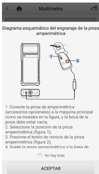
Figura 9-3 Diagrama esquemático de ejemplo de una pinza amperimétrica
