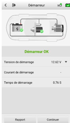
Figure 4 -7 Exemple d'écran de résultat de test de démarrage
