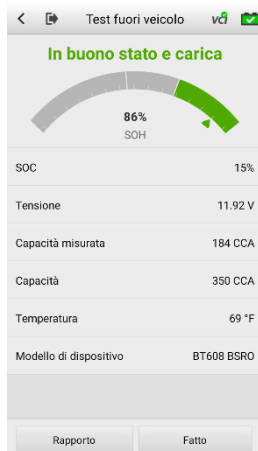
Figura 5-2 Schermata dei risultati del test fuori dal veicolo ( esempio)
