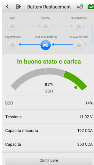
Figura 6-2 Esempio di schermata dei risultati del test di una nuova batteria
