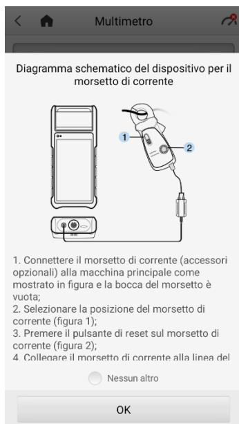
Figura 9-3 Esempio di schema di pinza amperometrica
