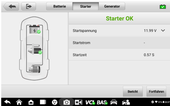
Abbildung 4-6 Ergebnisbildschirm des Startertests
