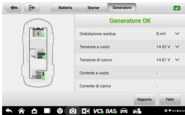
Figura 4-7 Schermata dei risultati del test del generatore
