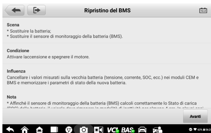
Figura 7-2 Schermata di ripristino BMS
