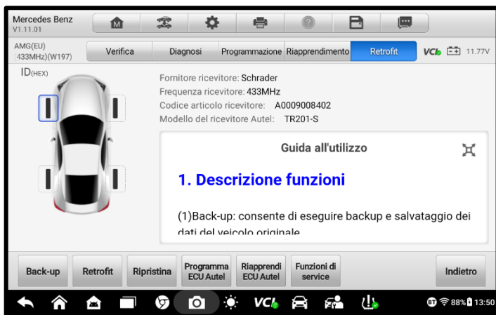
Figura8-1 Schermata di retrofit TPMS
