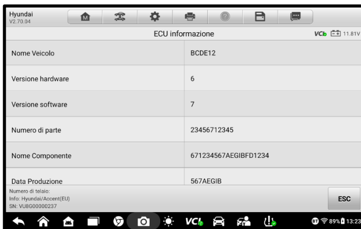
Figura6-15 Schermata informativa della centralina elettronica
