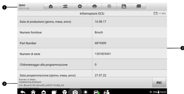
Figura 4-7 Schermata informativa della centralina elettronica (ECU)
