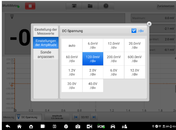
Figur7-77 Amplituden-Einstellbildschirm (DC 2,0 V/div)
