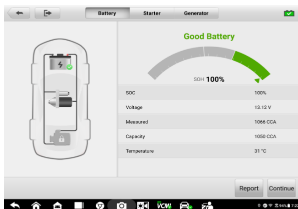
Postava9-7 Obrazovka s výsledky testu baterie
