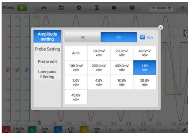
Kuvio7-42 Amplitudin asetusnäyttö (DC 1.0 V/div)
