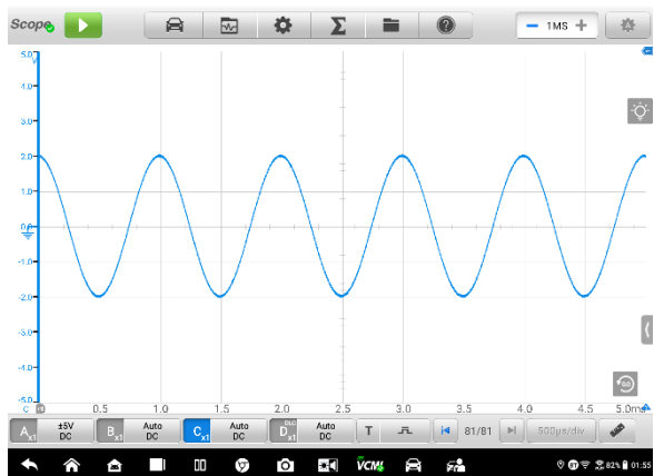
Chiffre7-35 Écran de marqueur de ligne de base zéro déplacé
