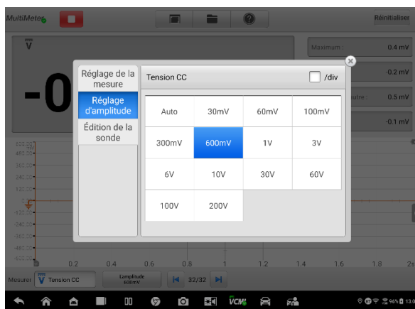
Écran 7-76de réglage de l'amplitude (DC 10 V)
