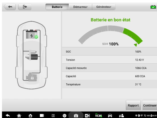
Chiffre9-7 Écran des résultats du test de la batterie
