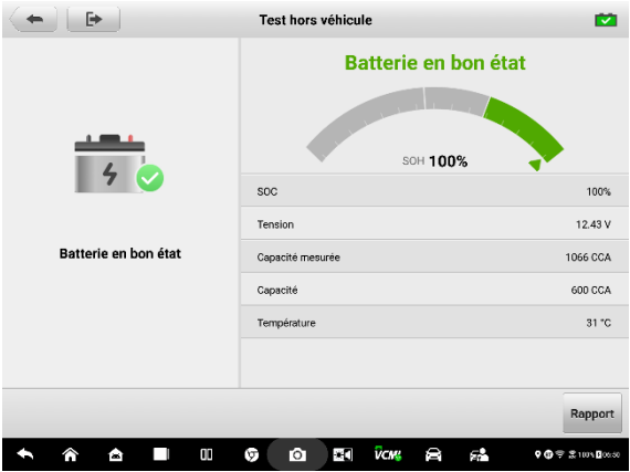
Chiffre9-11 Écran des résultats des tests hors véhicule
