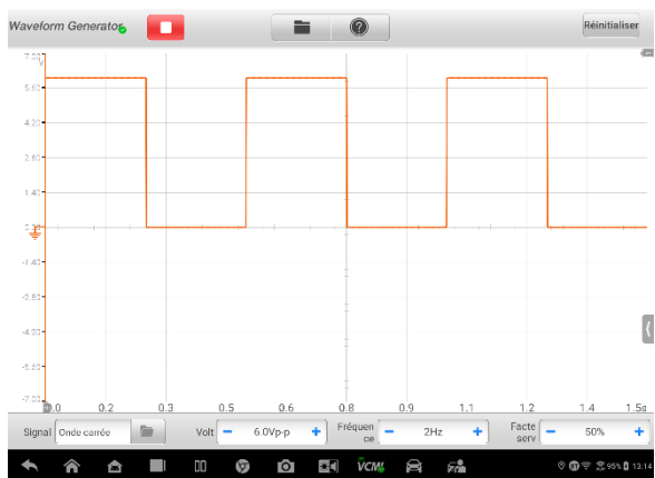
Chiffre7-104 Écran de réglage du cycle de service 1
