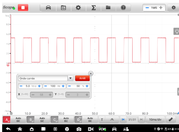
Chiffre7-23 Écran d'affichage du générateur de formes d'onde
