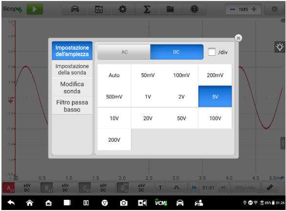
Figura7-41 Schermata di impostazione dell'ampiezza (5 V CC)
