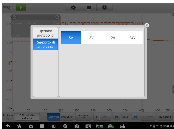
Figura7-124 Schermata di impostazione dell'ampiezza
