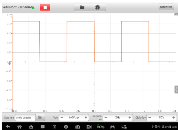
Figura7-104 Schermata di impostazione del ciclo di lavoro 1
