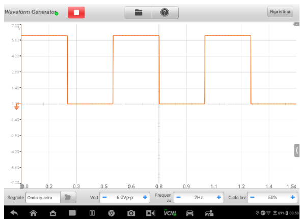
Figura7-101 Schermata di impostazione della frequenza 1
