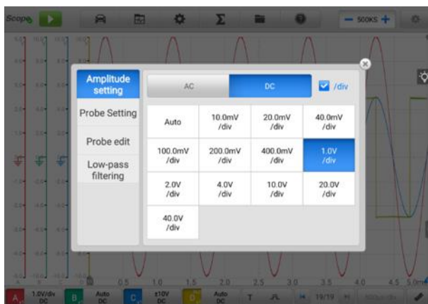
Figura7-42 Tela de ajuste de amplitude (DC 1,0 V/div)
