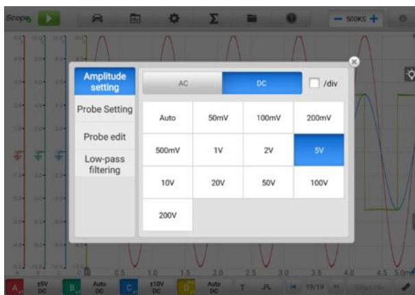
Figura7-41 Tela de ajuste de amplitude (DC 5 V)
