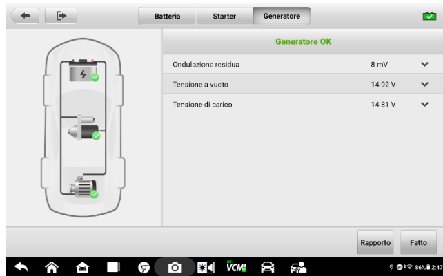
Figura12-9 Schermata dei risultati del test del generatore
