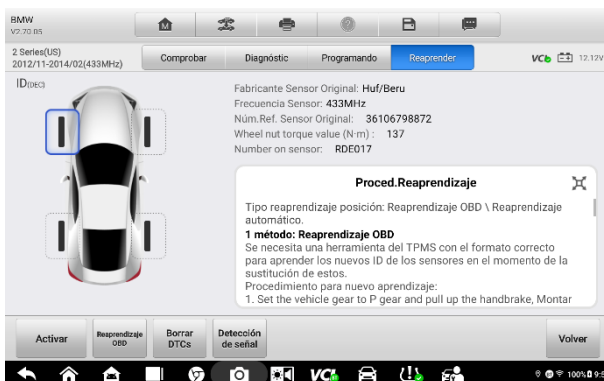
Figura 5-28 Pantalla principal de reaprendizaje de la función
