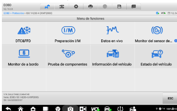
Figura 4-15 Menú de diagnóstico OBDII
