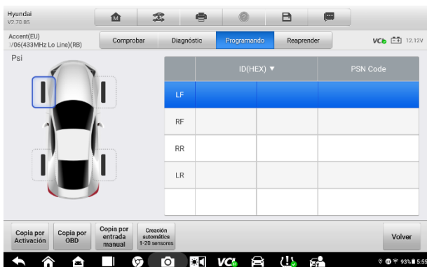
Figura 5-24 Pantalla de funciones de programación
