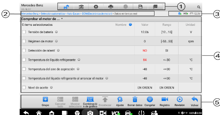
Figura 4-10 Pantalla de datos en tiempo real
