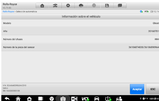
Figura 5-4 Información del vehículo en el TPMS
