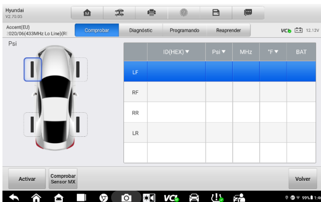
Figura 5-14 Pantalla de servicio del TPMS
