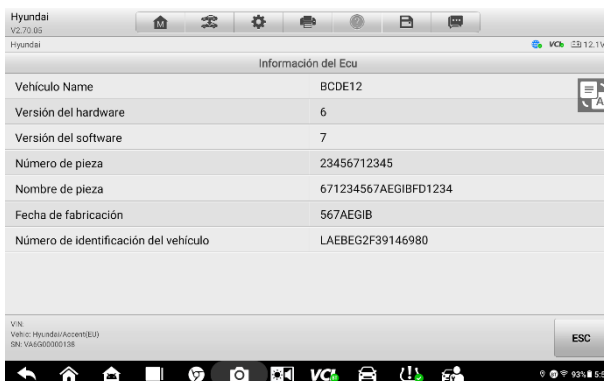
Figura 5-23 Pantalla de información de la ECU
