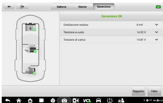
Figura 8-10 Schermata dei risultati del test del generatore
