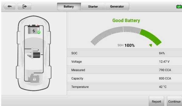
Afbeelding 8-6 Scherm met batterijtestresultaten
