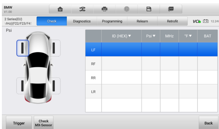
Figur 5-16 Skjermbilde for kontroll av funksjon
